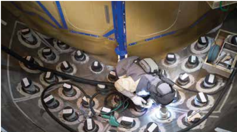
Soudage des manchettes d'un couvercle de cuve
