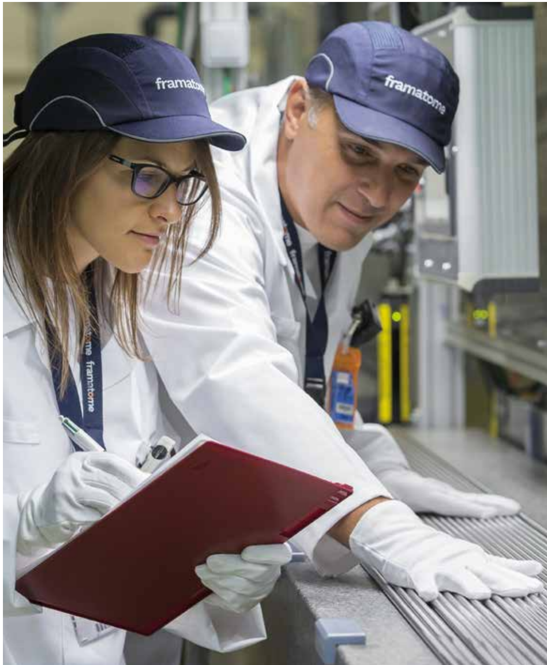
Contrôle visuel de gaines de combustible
