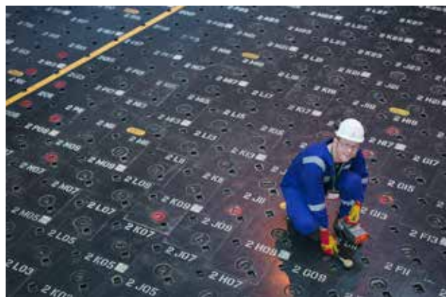
Mesure de débit de dose sur la dalle d'un réacteur AGR
