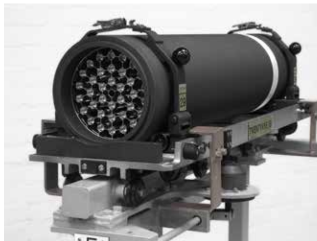
Une cartouche combustible de réacteur AGR
