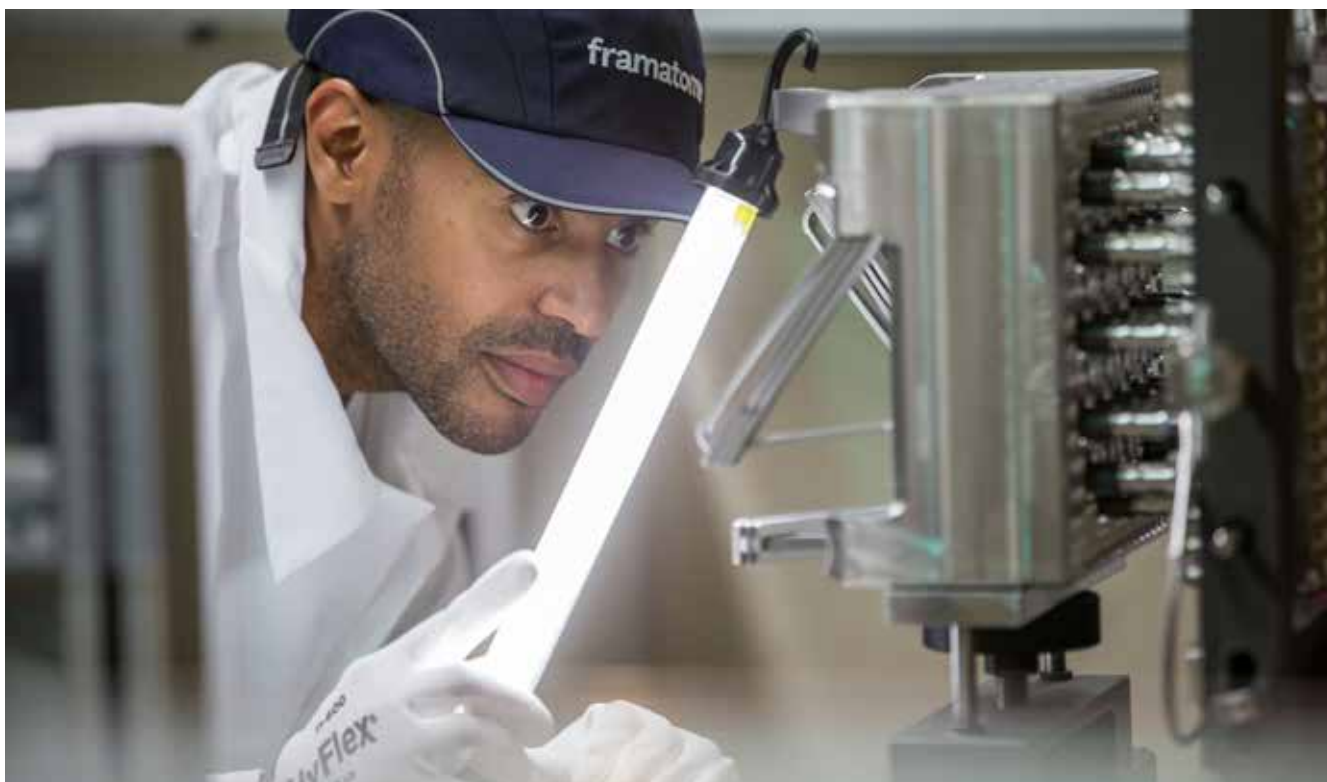
Contrôle lors de la fabrication d'un assemblage de combustible dans le site de Romans-sur-Isère
