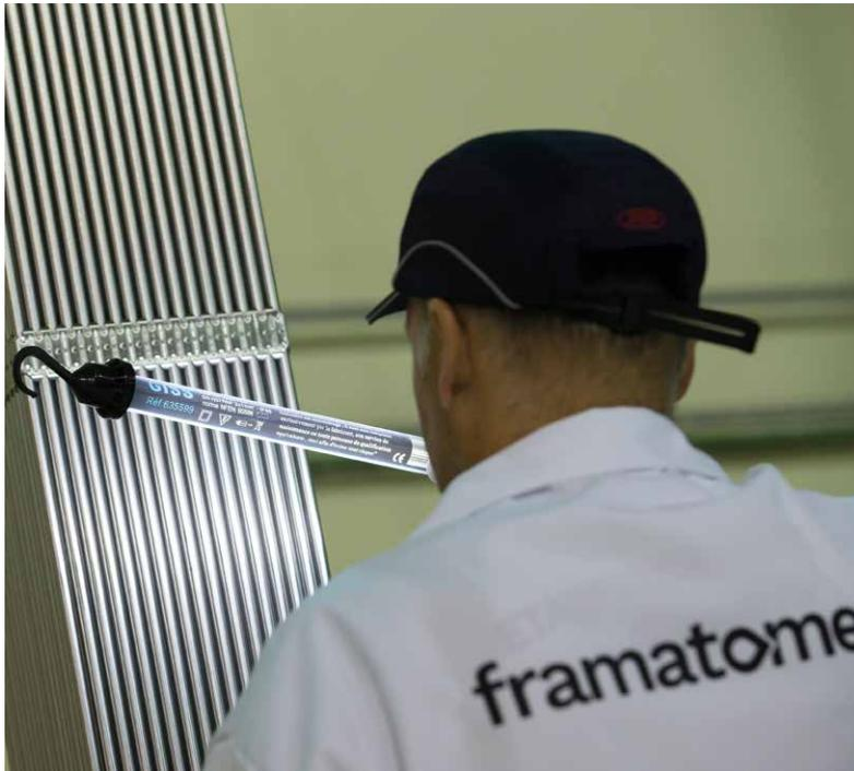
Romans-sur-Isère : contrôle visuel d'un assemblage combustible
